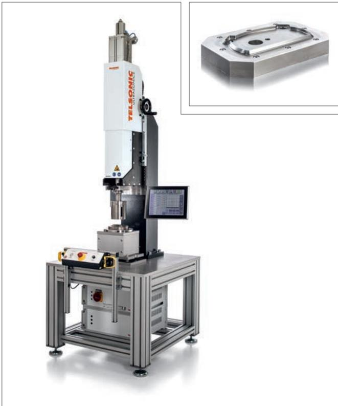
该应用通过配有工艺控制系统 TCS5 的 USP8000 型超声波分离焊接设备实现。与坯料的轮廓几何形状一致的硬质铁砧。
