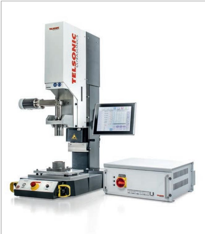
该应用通过配有 MAG 电箱的 SONIQTWIST® 扭转式设备 TSP3000 和焊接工艺控制系统 TCS5 实现。
