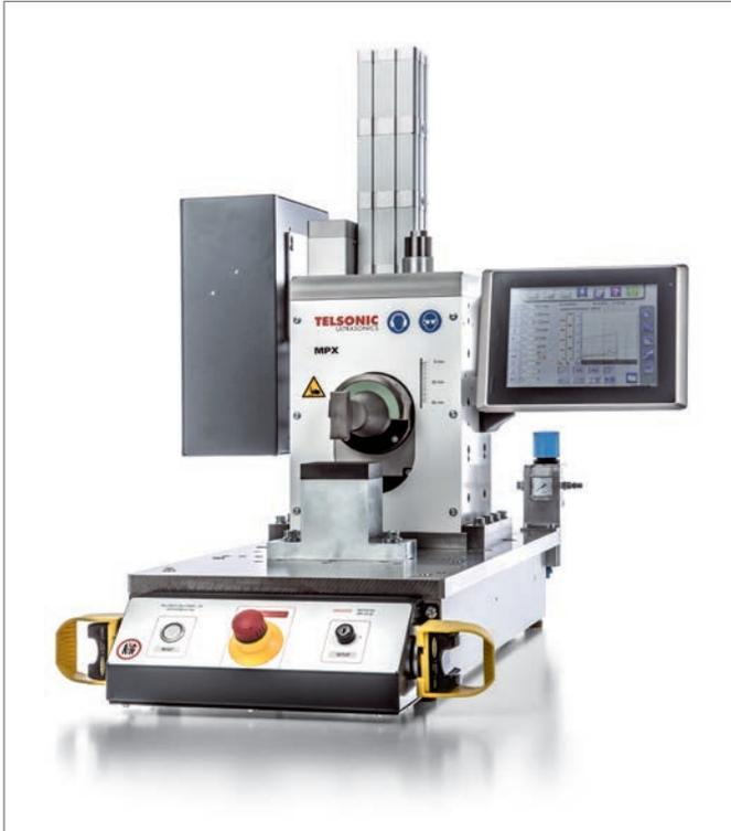
该应用通过频率为 20kHz 的线性金属焊接设备 MPX (3.6kW)、MAG 电箱和工艺控制系统 TCS5 实现。
