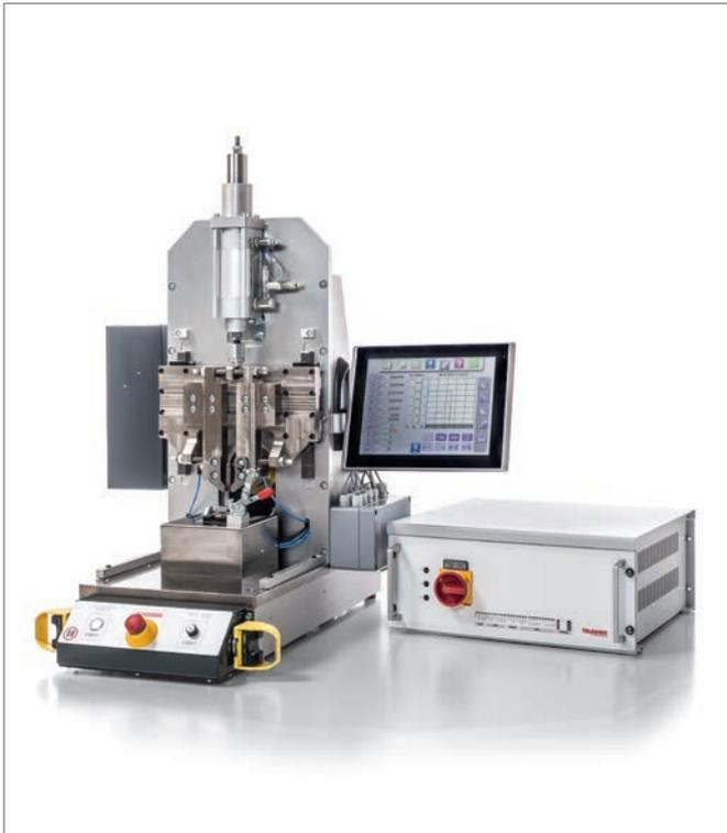
该应用通过频率为 20 kHz 的线性超声波焊接设备 MPX 以及相应的专用装置实现。
