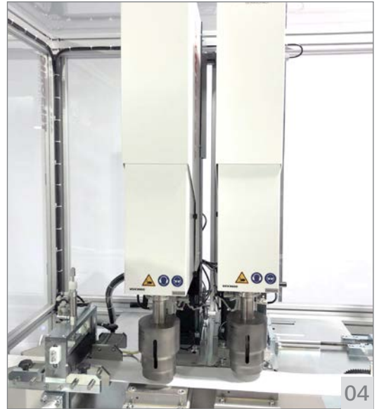
04 偏置型双超声焊极和砧座尽可能地提升了生产率，同时优化了材料利用率
