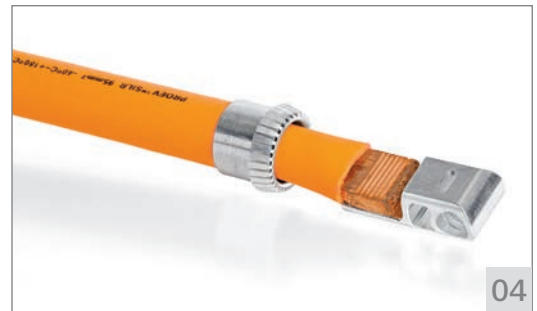
03 ProEV™ 线缆焊接至 Rosenberger 镀银连接器
