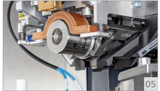
05 利用液冷回路将焊头和收拢器保持在所需的温度范围内
