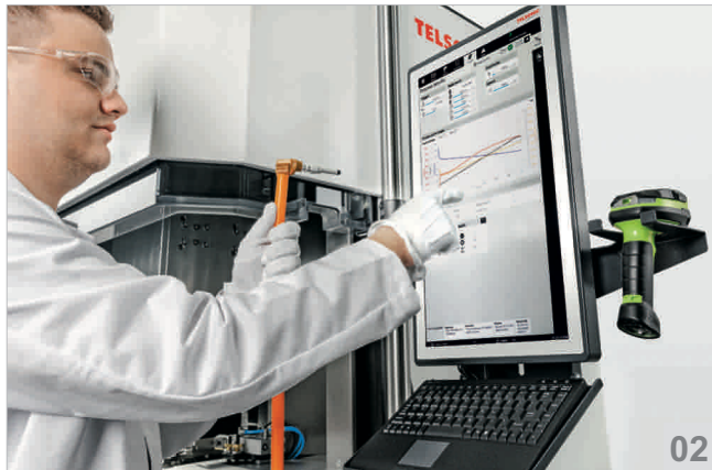
02 Telso®Flex 操作软件可以实现操作员与机器的完美交互，并始终提供有关焊接过程的反馈。通过这种方式，可以通过广泛的流程监控来满足高质量要求。（作者：Telsonic）
