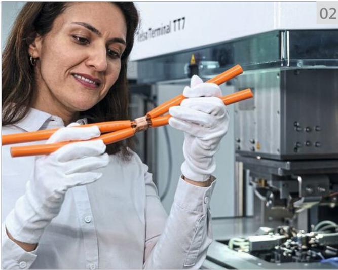
02 Shimaalsadat Mostafavi, Telsonic金属实验室负责人及应用架构师：“不久的将来，我们也将能够焊接铝管。即使在截面积方面，280 mm<sup>2</sup>也远非我们能力的极限。”
