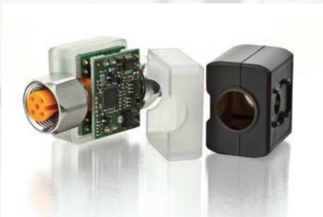
Capteur dans un boîtier en plastique
