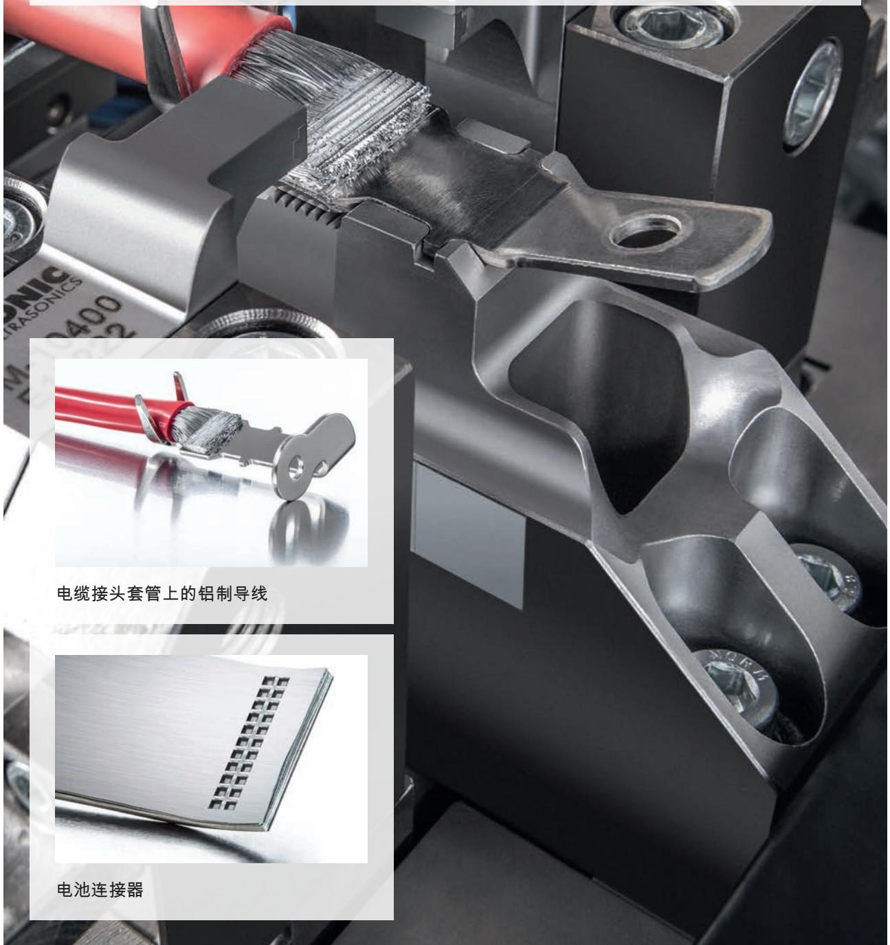
电缆接头套管上的铝制导线
