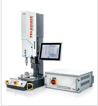
La aplicación se ha realizado en una instalación de soldadura por ultrasonidos USP750 (35 kHz/1.200 W) con generador MAG y controlador TCS5 o con los componentes correspondientes de una instalación especial.
