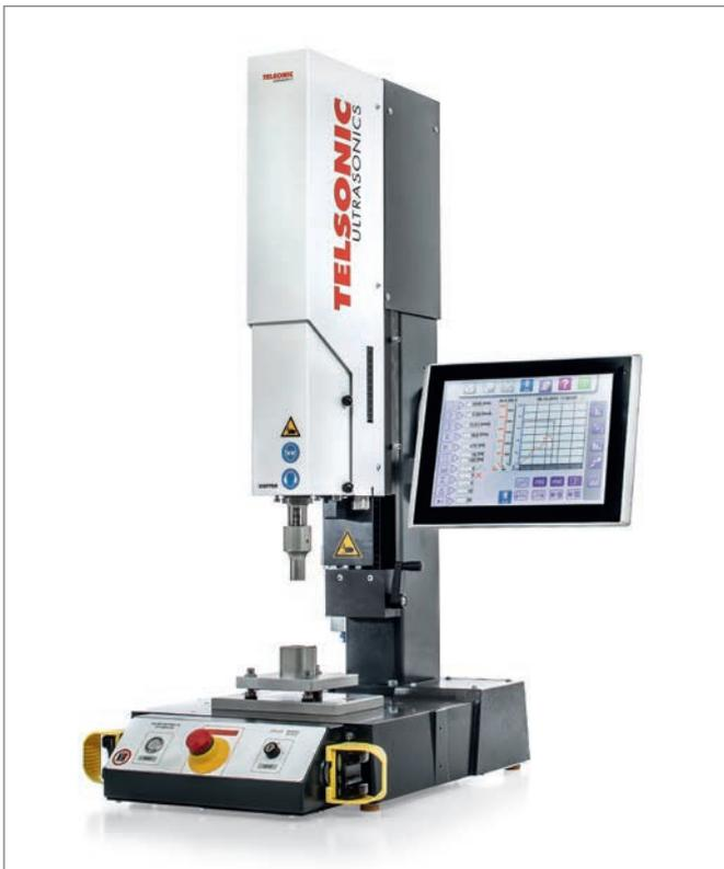
L'applicazione è stata creata su un impianto a ultrasuoni da 35 kHz del tipo USP750 con sistema differenziale di scansione pezzi e limitazione del movimento dei rivetti.
