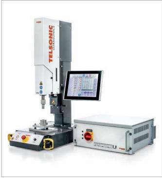
L'applicazione è stata creata su un impianto di saldatura a ultrasuoni a 35 kHz USP750 con generatore MAG e controllo di processo TCS5 comando touchscreen o con componenti integrati in una linea di produzione automatica.
