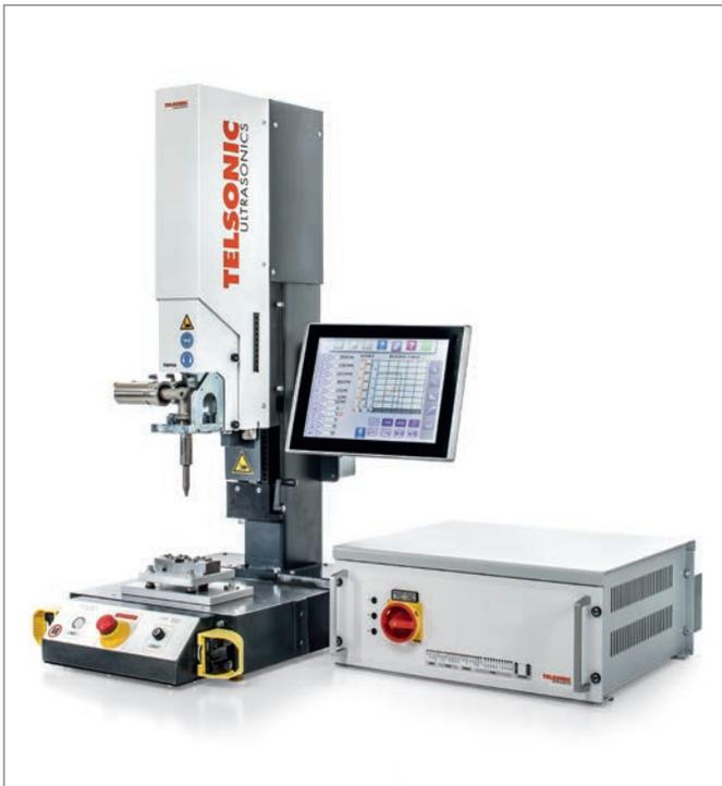
Die Applikation wurde auf einer torsionalen SONIQTWIST®-Schweissanlage TSP750 mit Generator MAG und Steuerung TCS5 bzw. mit entsprechenden Komponenten in einer Sonderanlage gebördelt.
