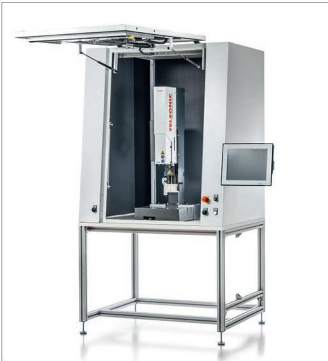
La aplicación se ha realizado en una instalación de soldadura por ultrasonidos de 20 kHz del modelo USP3000, con generador MAG y controlador de procesos TCS5 con cabina de protección acústica.
