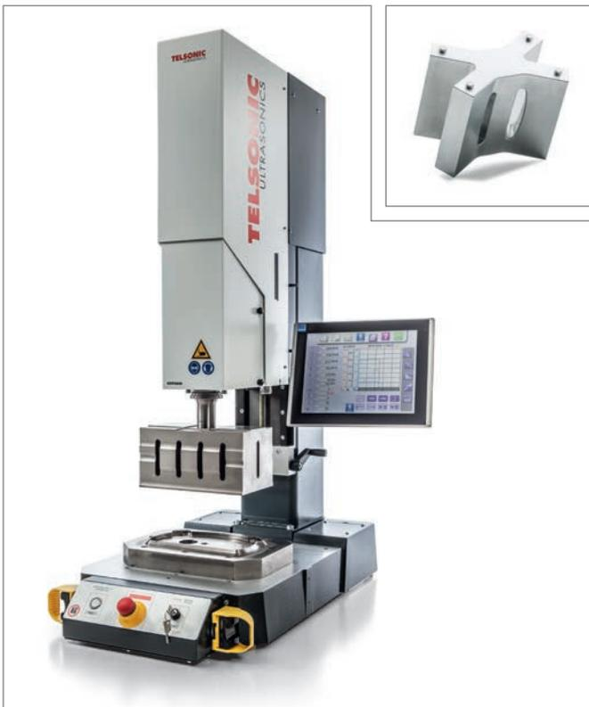
Die Applikation wurde erstellt auf einer 20 kHz-Ultraschallschweißanlage des Typs USP3000 und mit einer Sonotrode mit Mehrfachkontur.
