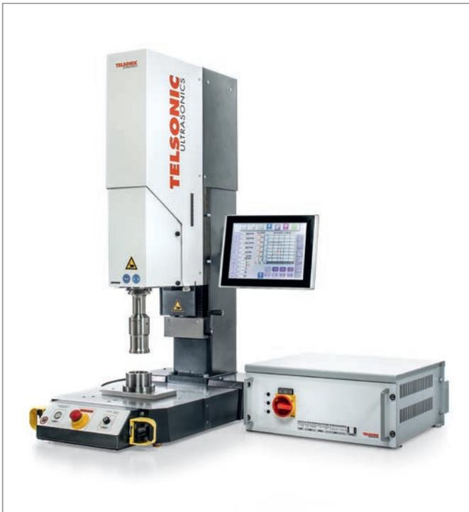
La aplicación ha sido realizada en una instalación de soldadura ultrasónica de 20 kHz USP3000 con generador MAG y controlador de procesos TCS5.
