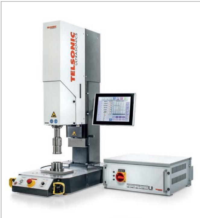
La aplicación se ha realizado en una instalación de soldadura por ultrasonidos de 20 kHz del modelo USP3000, con generador MAG y controlador TCS5.
