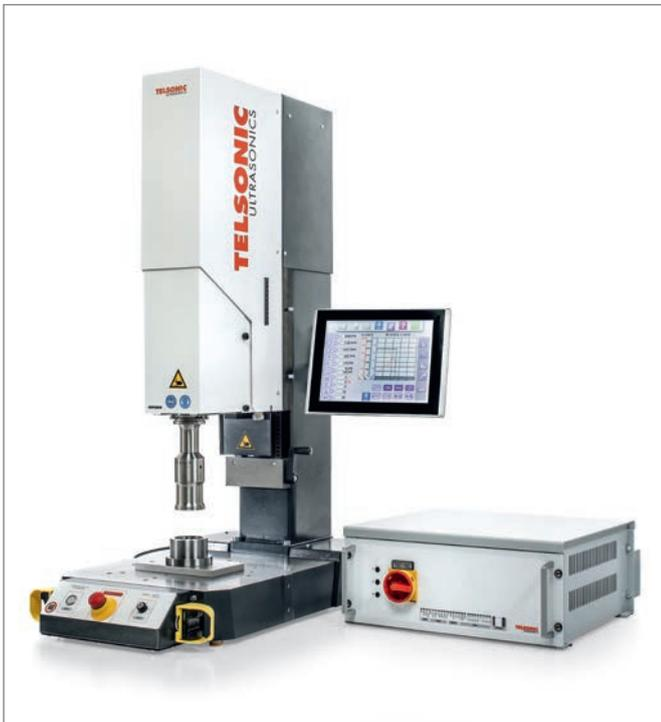
La aplicación se ha realizado en una instalación de soldadura por ultrasonidos de 20 kHz del modelo USP3000, con generador MAG y controlador TCS5 con administración de conjunto de datos y control de procesos.
