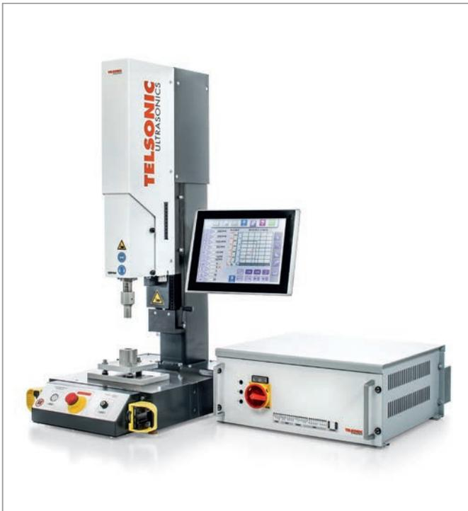
La aplicación ha sido realizada en una instalación de soldadura ultrasónica de 35 kHz USP750 con generador MAG 1.200W y controlador de procesos TCS5.
