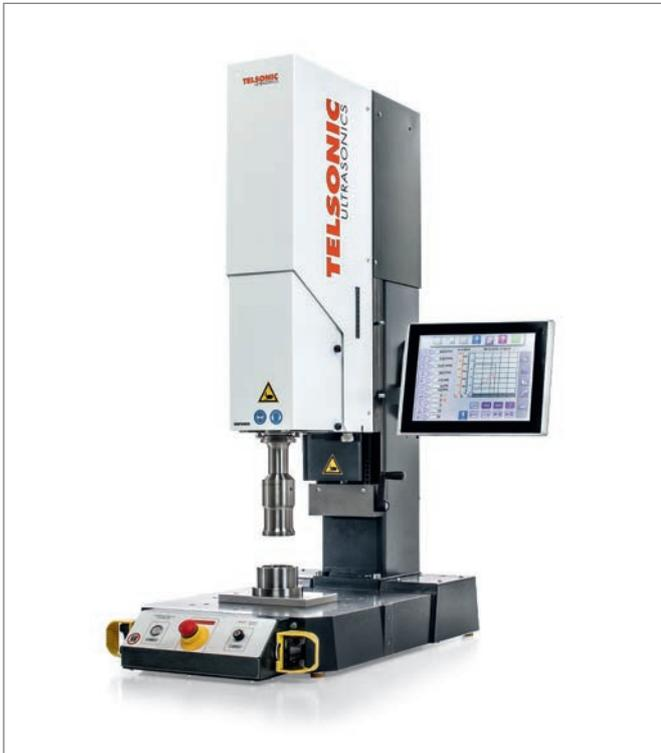
Die Applikation wurde erstellt auf einer 20 kHz-Ultraschallschweißanlage, Typ USP3000 mit Prozesssteuerung TCS5 und Generator MAG 4.8 kW.
