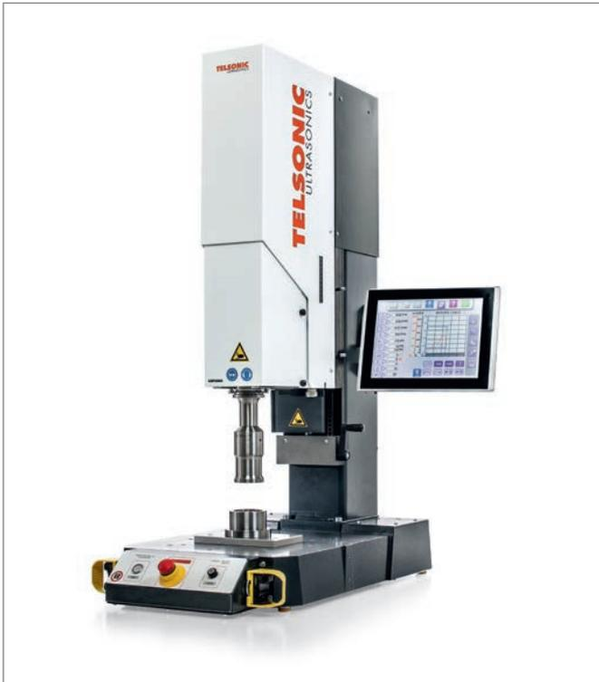
L'applicazione è stata creata su un impianto di saldatura a 20 kHz del tipo USP30000 con generatore MAG da 3600 W e comando di processo TCS5 con touchscreen.
