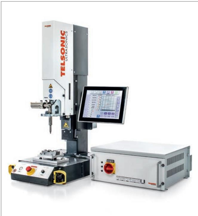
Die Applikation wurde erstellt auf einer torsionalen SONIQTWIST®-Schweißanlage TSP750 mit Generator MAG und Steuerung TCS5 bzw. mit entsprechenden Komponenten in einer Sonderanlage.
