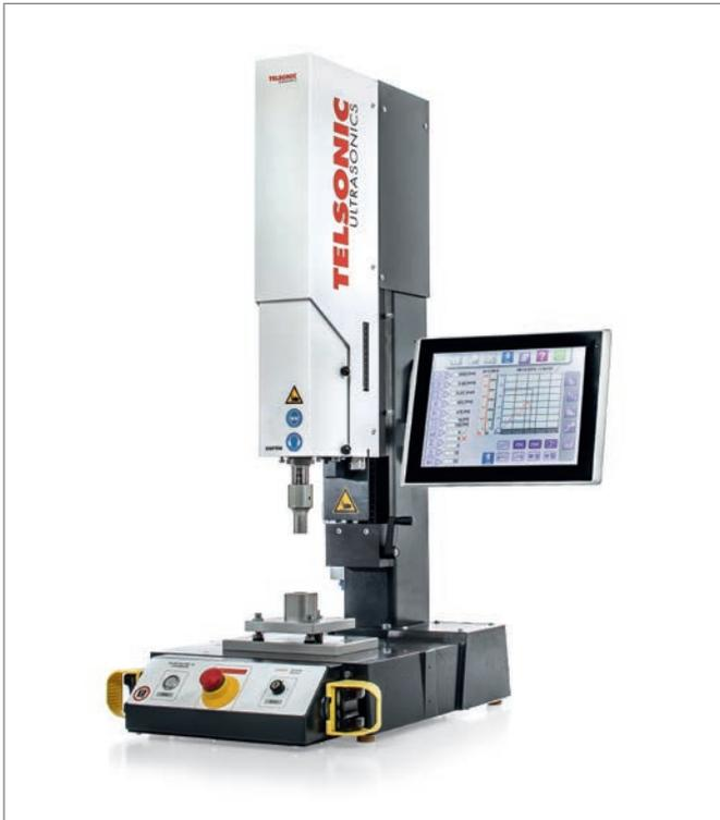
L'applicazione è stata creata su un impianto di saldatura da 35 kHz USP750 e un comando TCS5 o integrato con i componenti corrispondenti in un impianto di produzione.
