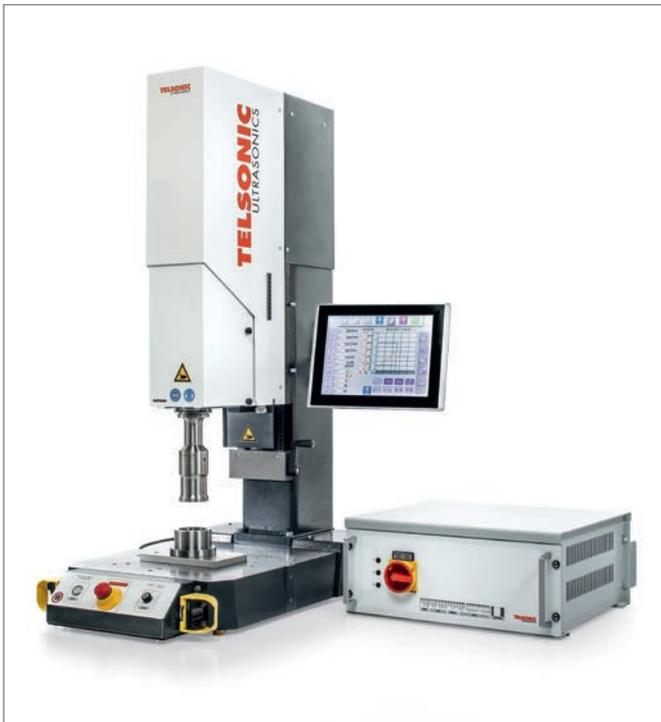
La aplicación se ha realizado en una instalación de soldadura de 20 kHz del modelo USP3000, con generador MAG de 3.600 W y controlador de procesos TCS5 con manejo por pantalla táctil.
