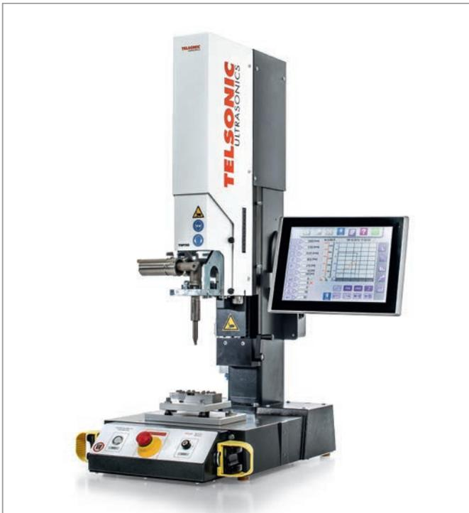
Die Applikation wurde auf einer torsionalen SONIQTWIST®-Anlage TSP750 realisiert bzw. mit entsprechenden Komponenten in einer Sonderanlage.
