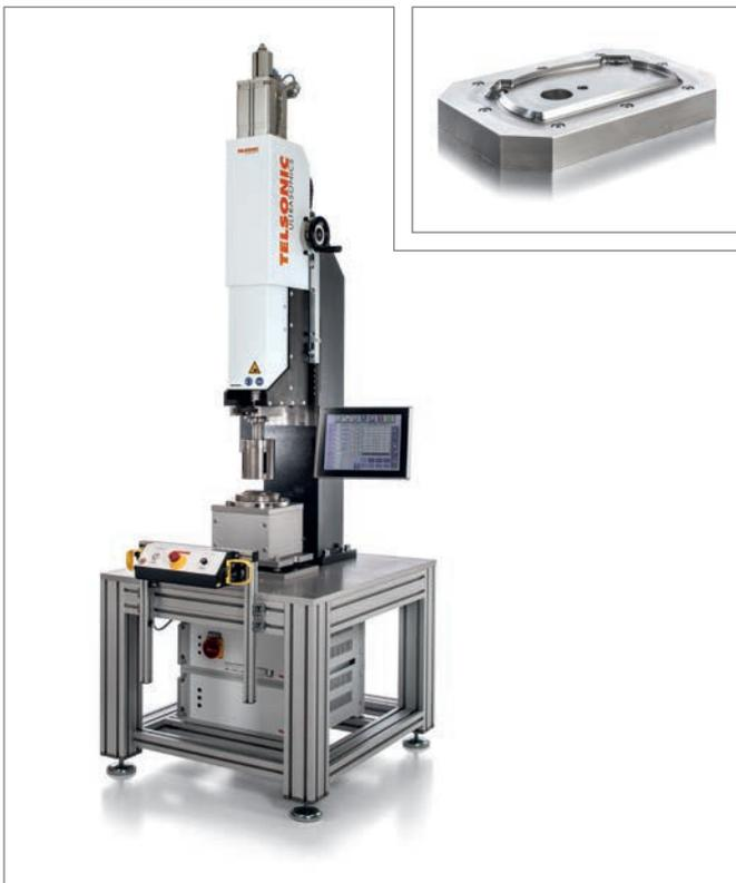
Die Applikation wurde erstellt auf einer Ultraschall-Trennschweissanlage des Typs USP8000 mit Prozesssteuerung TCS5. Gehärteter Amboss mit Konturgeometrie der Zuschnitte.
