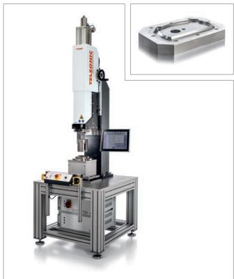
La aplicación se ha realizado en un equipo de corte y soldadura por ultrasonidos del modelo USP8000 con controlador de procesos TCS5. Yunque endurecido con geometría de contorno de los cortes
