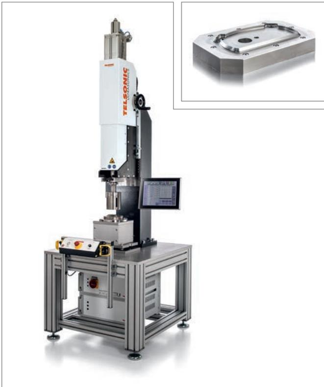
L'applicazione è stata realizzata su un impianto di taglio e saldatura a ultrasuoni del tipo USP8000 con comando di processo TCS5. Incudine in acciaio temprato con geometria dei bordi dei tagli.
