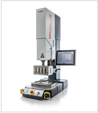
Le applicazioni sono state realizzate con diversi impianti di saldatura a ultrasuoni da 20 e 35 kHz della serie USP o componenti corrispondenti, integrati in un impianto speciale.
