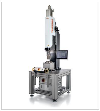
Las aplicaciones se han creado en una instalación de soldadura del modelo USP8000 con las correspondientes herramientas de proceso de 2 etapas y un controlador TCS5 con selección de juegos de datos.
