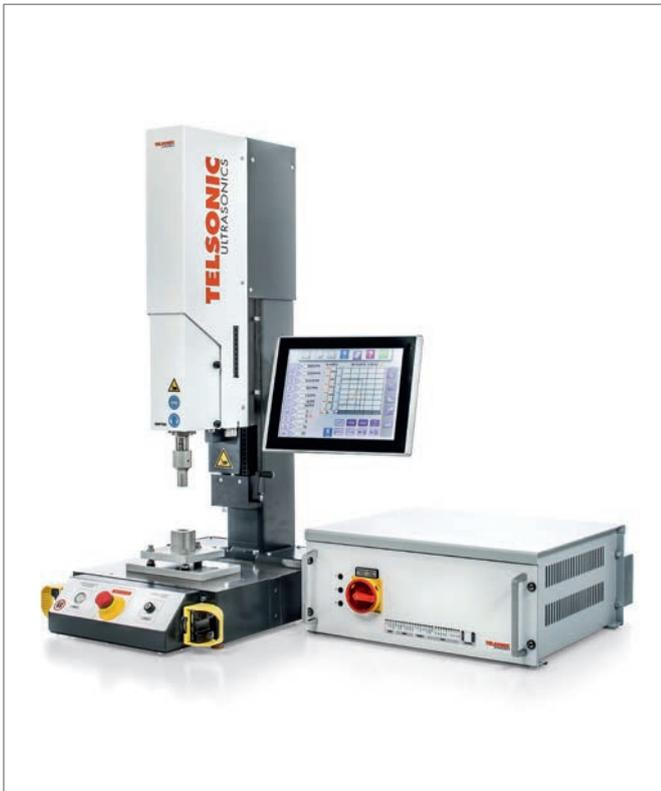
La aplicación se ha realizado con los componentes de un equipo de soldadura USP750/3000, con generador MAG y controlador de procesos TCS5, integrados en una instalación especial.
