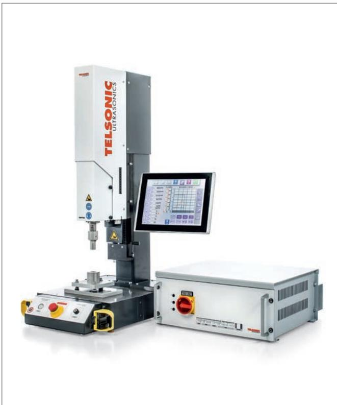
L'applicazione è stata creata con componenti di un impianto di saldatura USP750/3000 con generatore MAG e comando di processo TCS5, integrati in un impianto speciale.
