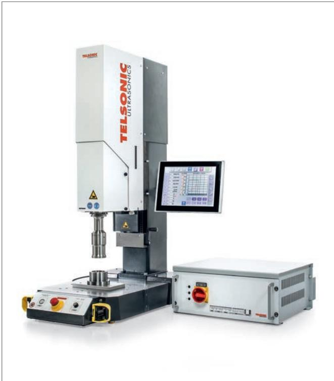
L'applicazione è stata creata su un impianto di saldatura a ultrasuoni USP3000 a 20 kHz con generatore MAG e comando di processo TCS5, o con componenti appositi integrati in uno speciale impianto con collegamento bus.
