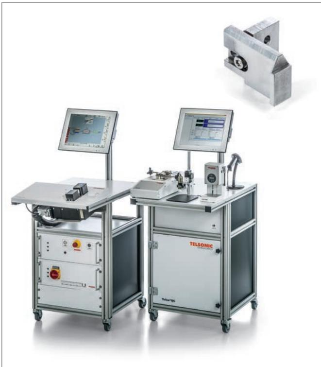
Las aplicaciones se han realizado en un equipo de soldadura de cordón Telso®Splice TS3 con tope final. Control de calidad con TELSONIC Quality Control Center TQCC.
