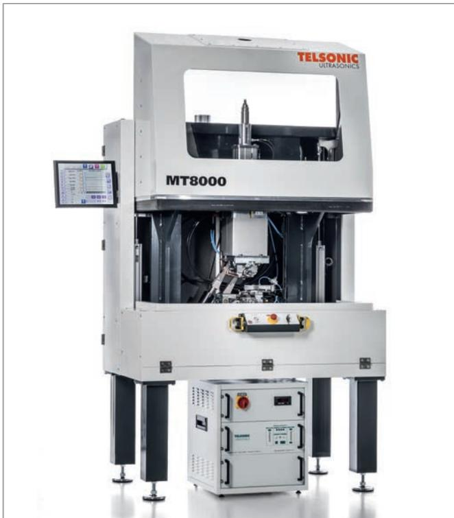
La aplicación se ha fabricado en un equipo PowerWheel® MT8000, con una potencia de 10 kW, protección acústica elevable y controlador de procesos de soldadura TCS5.
