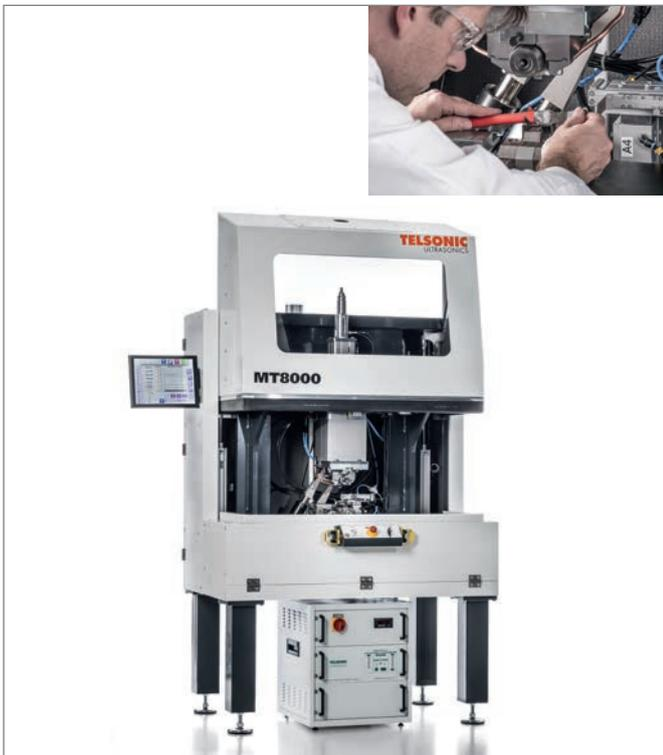
La aplicación se ha realizado en un equipo PowerWheel® MT8000 de 10 kW con un controlador de procesos de soldadura TCS5.
