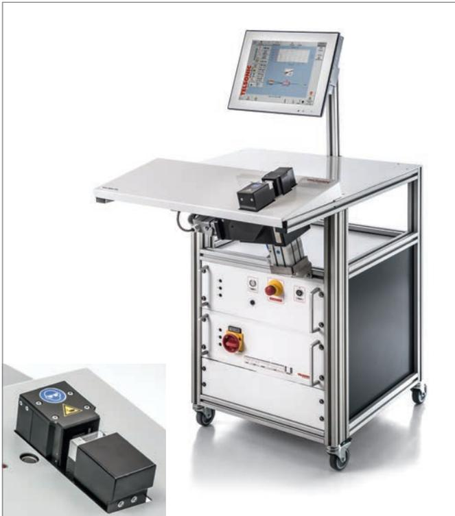
Questa e simili applicazioni vengono realizzate, a seconda della sezione totale, su un impianto di saldatura per cavetti di tipo Telso®Splice TS3 o TS6.
