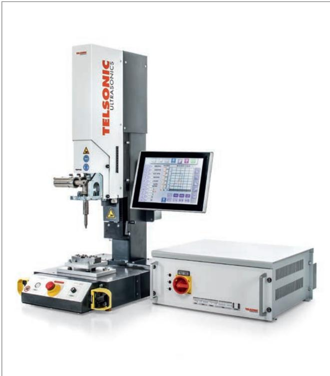
L'applicazione è stata realizzata su un impianto torsionale SONIQTWIST® TSP750 1,2 kW e comando di processo TCS5 o con componenti appositi installati in uno speciale impianto.
