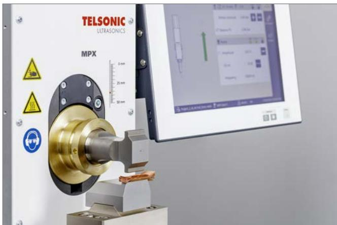
Die Applikation wurde erstellt auf einer modularen 20 kHz-Ultraschallschweissanlage des Typs MPX und Steuerungssoftware Telso®Flex bzw. mit entsprechenden Komponenten, integriert in eine Sonderanlage.
