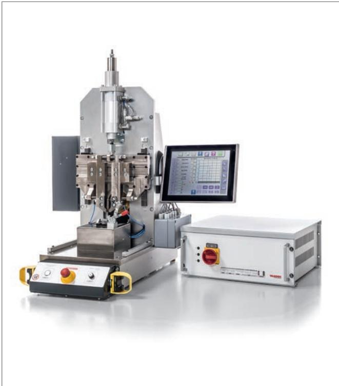
L'applicazione è stata realizzata su un impianto di saldatura a ultrasuoni lineare di tipo MPX, potenza 3,6 kW, con relativo dispositivo speciale.
