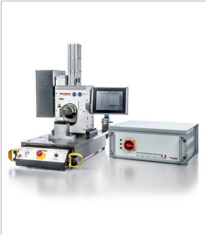
L'applicazione è stata saldata su un impianto di saldatura a ultrasuoni lineare da 20kHz MPX con comando di processo TCS5, generatore MAG e sonotrodo quadruplo.
