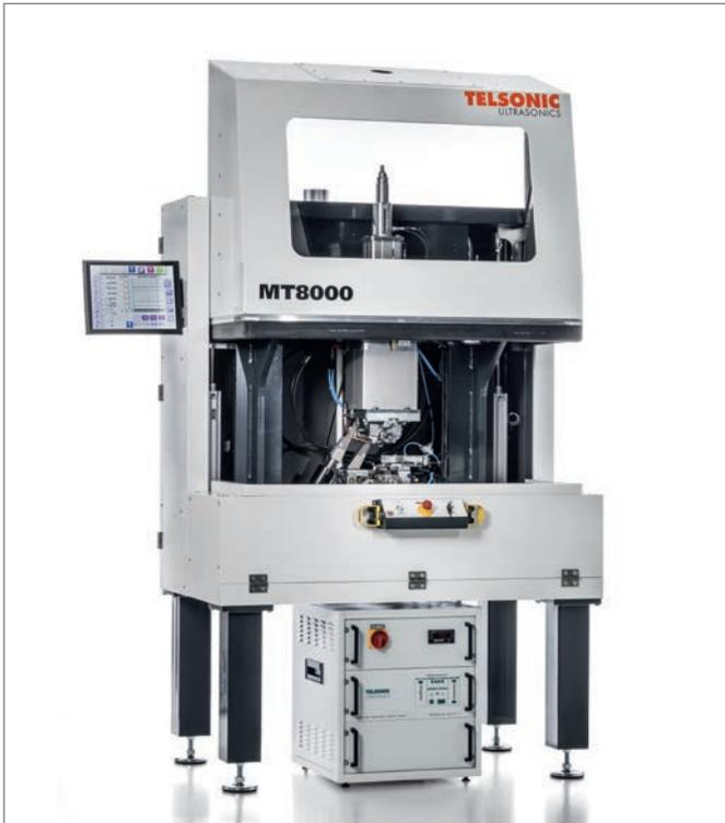
Die Applikation wurde auf einer 10 kW-PowerWheel®-Anlage MT8000 und Schweißprozesssteuerung TCS5 geschweisst.
