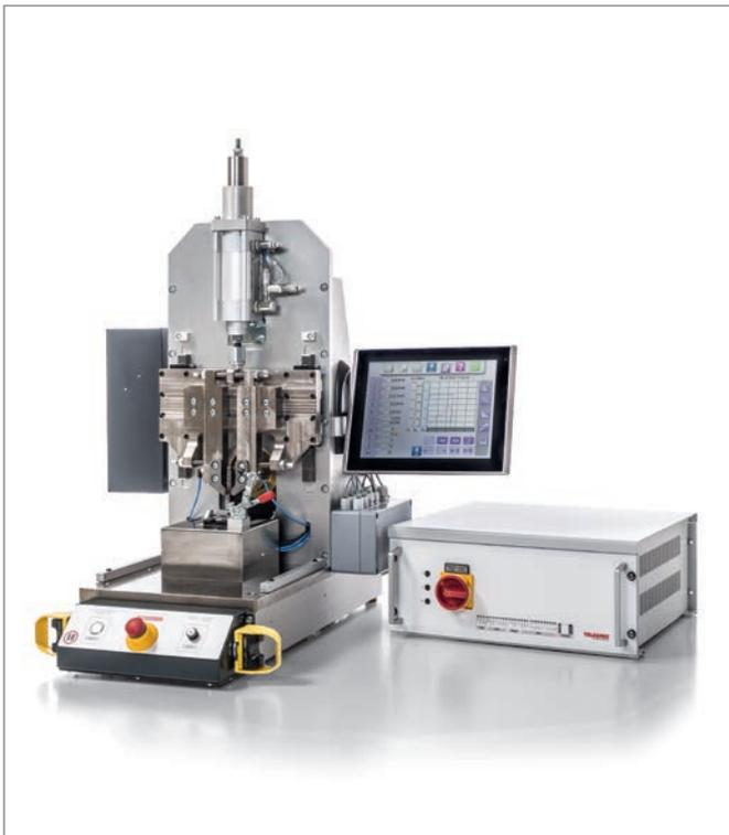
La aplicación se ha realizado en un equipo de soldadura lineal por ultrasonidos del modelo MPX, con una frecuencia de 20kHz, y en el dispositivo especial correspondiente.
