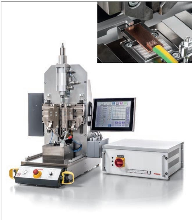
Die Applikation wurde auf einer linearen Ultraschallschweißanlage des Typs MPX, Frequenz 20 kHz, und entsprechender Spezialvorrichtung realisiert.
