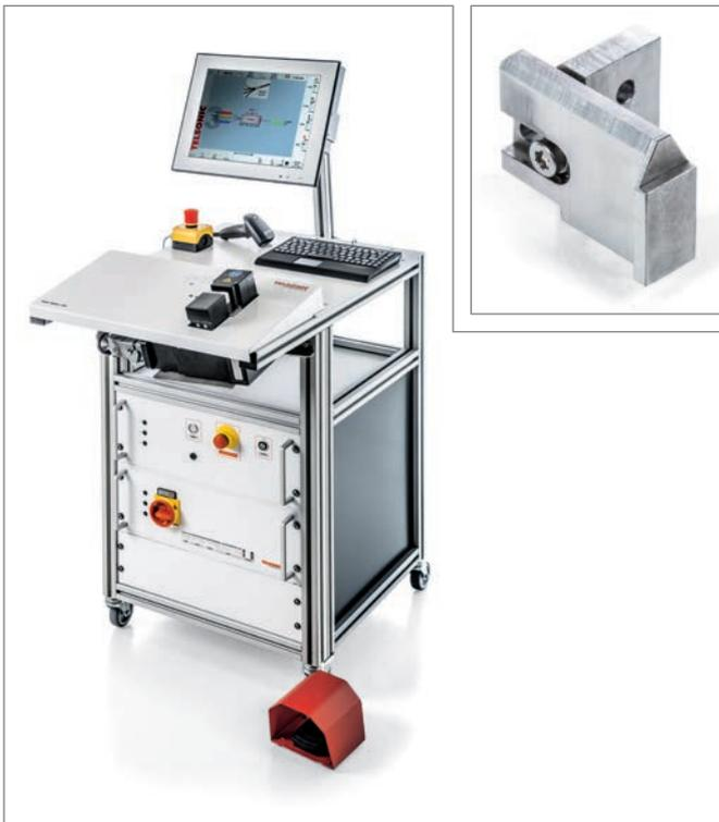
La aplicación se ha realizado en un equipo de soldadura de cordón Telso®Splice TS3 de 3,6kW de potencia con tope de cordón.
