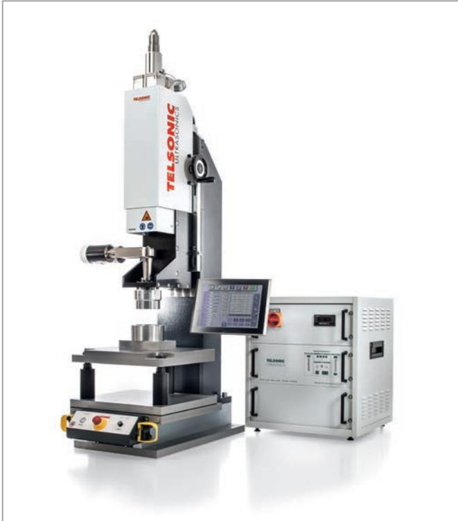
La aplicación se ha realizado en un equipo de soldadura helicoidal SONIQTWIST® TSP8000/10kW, integrado en una instalación especial con los componentes correspondientes.
