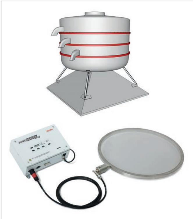
Das Pulver für Tabletten und Pillen wird in einer Vibrationssiebmaschine mit SONOSCREEN®easy-Ultraschallunterstützung gesiebt.
