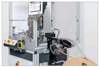
Die Applikation wurde auf einer linearen Ultraschallschweissanlage des Typs MPX, Frequenz 20 kHz und einer entsprechender Spezialvorrichtung realisiert.
